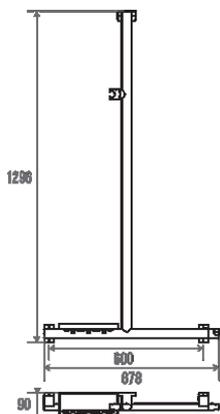
Tube elliptique 38x25 mm en aluminium époxy blanc. Cache-fixations en résine de synthèse blancs.
